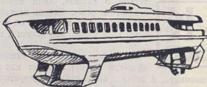
К днищу «Ракеты» приделаны четыре обтекаемых крыла, на корме установлен винт.
